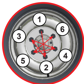
Sequência de aperto da porca do flange da roda. "ALCANCE 8T"
